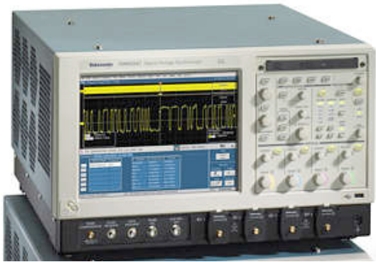
Tektronix TDS6124C 12 GHz, 40 GS/s
